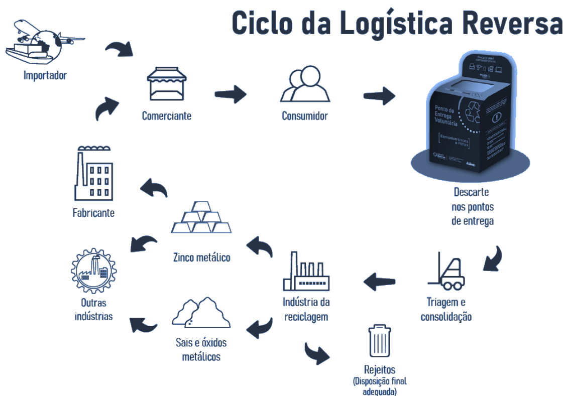
Figura 70: Ciclo da Logística Reversa de Pilhas e Baterias.
